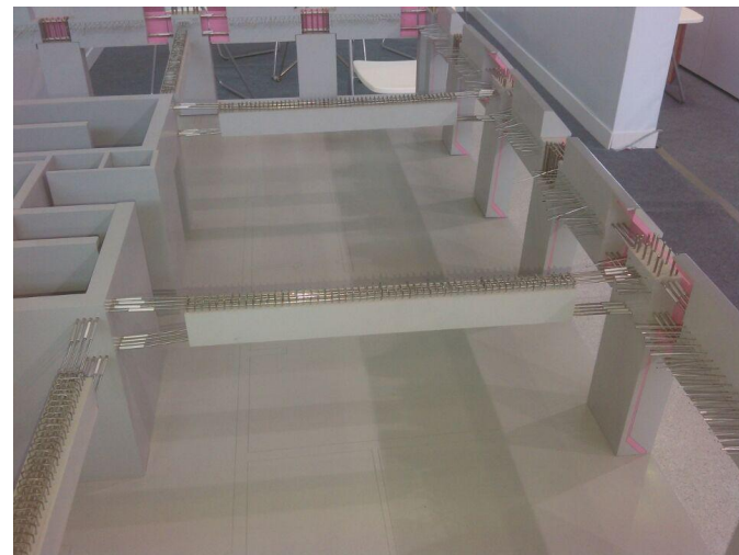
框架-剪力墙结构体系
